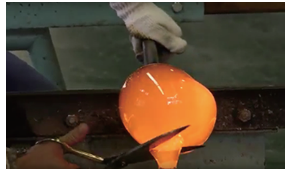
溶けたガラスの成形 カガミクリスタル「工場見学」より
